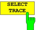
Der Softkey *SELECT TRACE* wählt die Messkurve aus, deren Daten in der unteren Bildschirmhälfte dargestellt werden.
