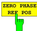
Der Softkey *ZERO PHASE REF POS* legt die Position fest, an der die Phase des PM-demodulierten Signals zu 0 rad gesetzt wird. Die Eingabe erfolgt auf Zeitbasis. In der Grundeinstellung wird der erste Messwert auf 0 rad gesetzt. Der Softkey ist nur in der PM-Darstellung mit DC Kopplung verfügbar.
